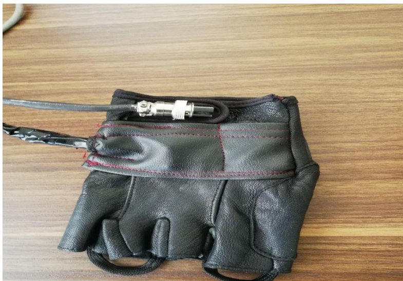
شکل ۱: دستکش مجهز به مدار فرمان و سنسور سنجش حرکت
