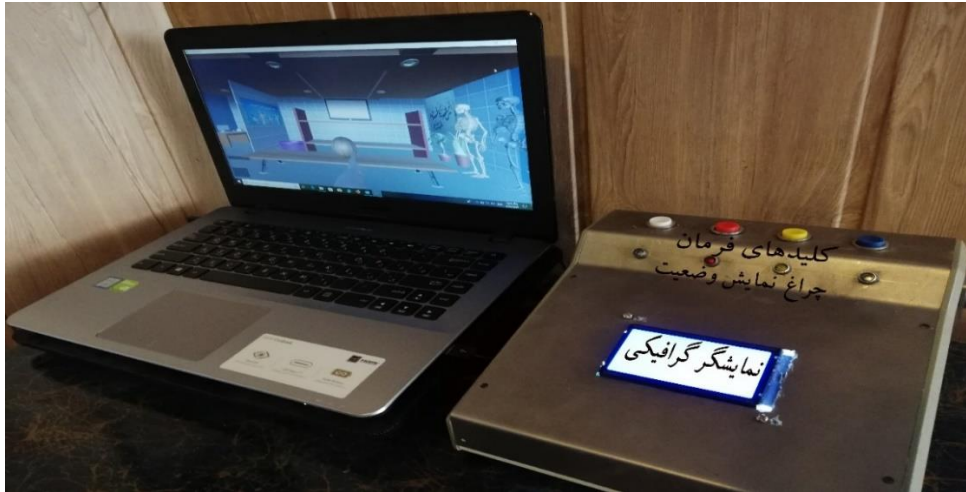
شکل ۳: تابلوی کنترل طراحی شده
